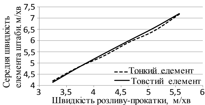
Рис. 5. Залежність швидкості елементів профільованої штаби від швидкості розливу-прокатки
