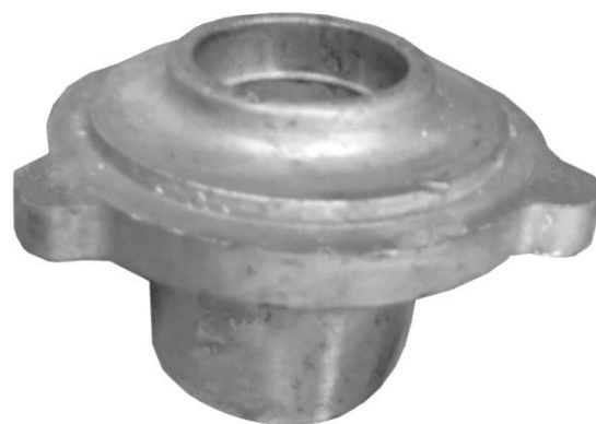
Рисунок 11 – Виливок-представник «Кришка» зі сплаву АК5М2
