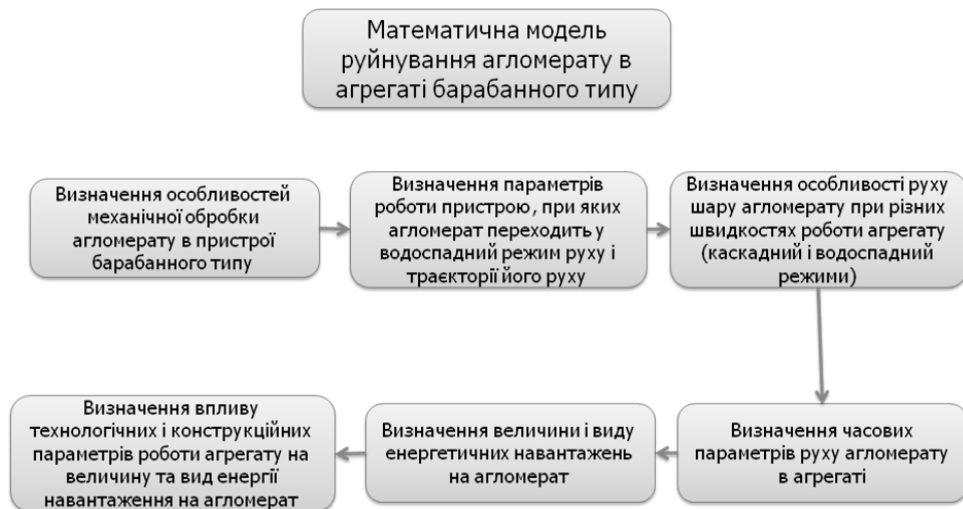
Рисунок 6 – Структура моделі руйнування агломерату в агрегаті барабанного типу
