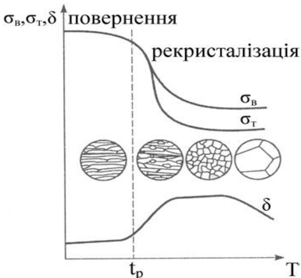
Рис. 3 - Зміна характеристик міцності ( \sigma_B , \sigma_{0,2} ) і пластичності ( \delta ) наклепаного металу при нагріванні; t_p – температура початку рекристалізації.
