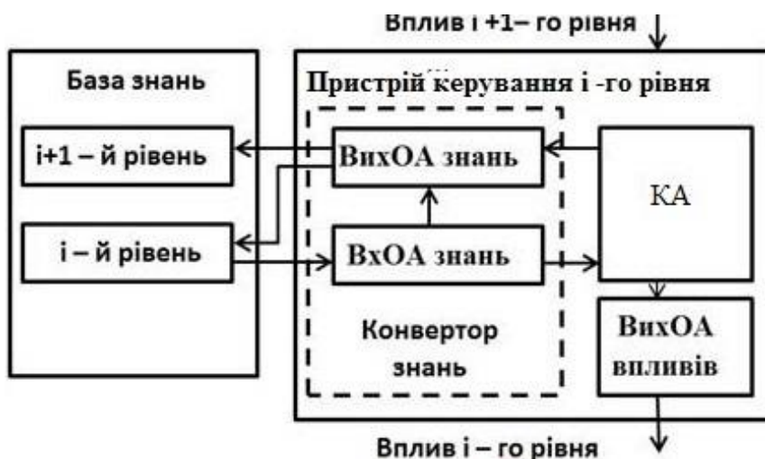
Рисунок 8 – Узагальнена структура конвертора i -го рівня керування
