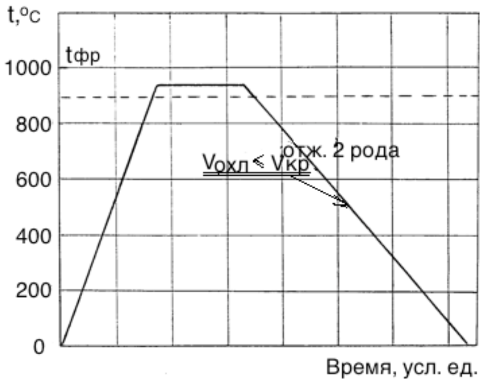
Рис. 4.3. Пример схемы оформления рисунка с построением графиков – схем режима отжига 2-го рода
